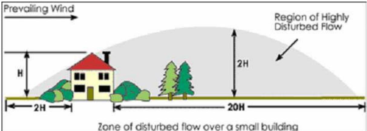
Sollte die optimale Platzierung des Windgenerators Ihnen baulich nicht gelingen, wählen Sie am besten den Montageort in der Richtung, aus welcher der Wind am häufigsten weht.
