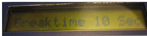
Mit Breaktime, können Sie die Zeit bestimmen, um den Windgenerator anzubremsen. Je höher die Zeit eingestellt ist, desto länger dauern die ersten Bremsvorgäng, dadurch heizen sich dann die Bremswiderstände auf und die Dauerbremsung kann erfolgen, bis die
