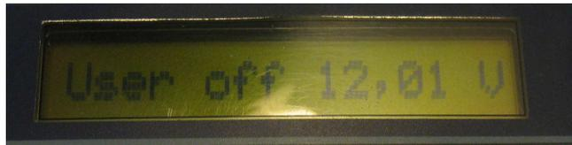
Mit der + und – Tasten können Sie einstellen, bei welcher Spannung der Laderegler den Verbraucher Abschalten soll.
