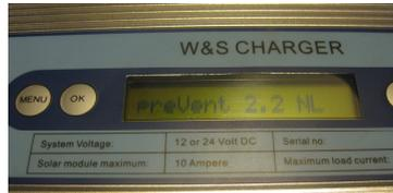
Logo, Stand der Version, N= Normalmenü, L für 12 Volt, H für 24 Volt Systemspannung. Die Systemspannung wird selbst erkannt, sobald das Gerät an die Batterie angeschlossen wird. Ist die Batterie bei einer 24 Volt anlage tief entladen, kann es passieren, dass der Laderegler ein 12 Volt System erkennt.
