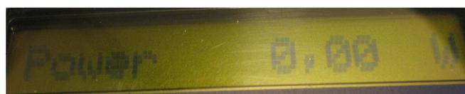
Es wird Ihnen die Leistung in Watt angezeigt, welche im Moment erzeugt wird.
