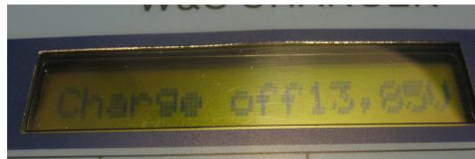
Bei dem Punkt Charge off, sollen Sie mit der + und – Taste, die Ladeschlussspannung Ihrer Batterien einstellen, beachten Sie bitte dazu die Angaben des Batteriehersteller, die Ladeschlußspannung kann je nach Batterietyp zwischen 12 und 15 Volt liegen.
