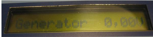
Es wird Ihnen die Generatorspannung angezeigt, diese startet erst ab 8 Volt, da vorher nur die Versorgungsspannung des Prozessors angezeigt wird. Die Generatorspannung, ist höher als die Batteriespannung.
